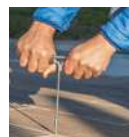
Clé d'ajustement Permet d'ajuster la hauteur une fois le revêtement posé
