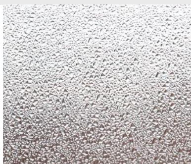
Vitrage goutte d'eau
