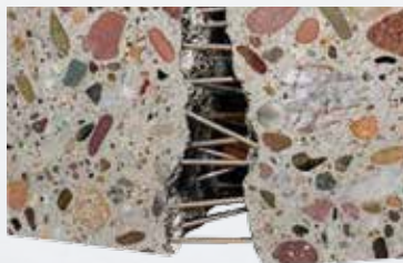
Fibre métallique anti-fissuration du béton
